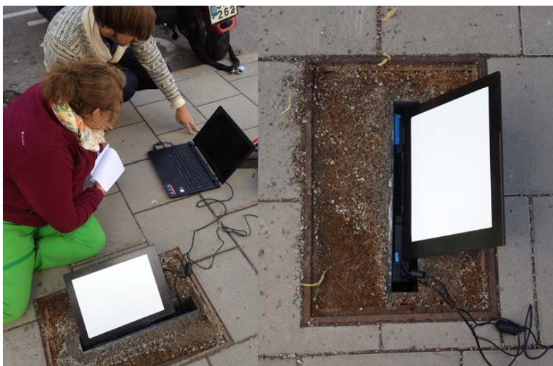
Figur 8. Skanning av rötter Blekingegatan i Stockholm. Bilden till vänster visar hopkopplingen skanner, dator och batteri. Bilden till höger är en närbild på skannern nersänkt i den plexiglaslåda som är installerad på platsen.
