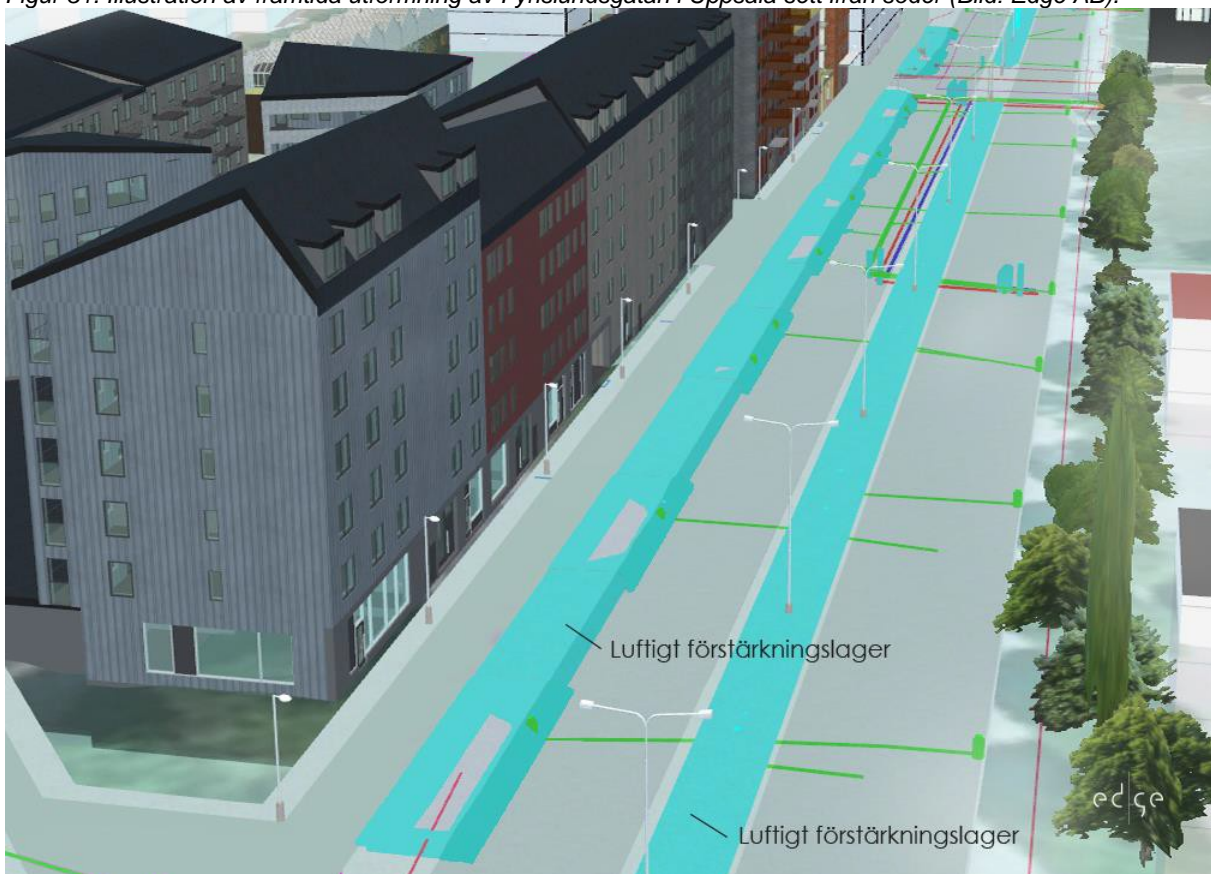
Figur 32. Illustration över utbredning av luftigt förstärkningslager i ljusblått och grönt för Fyrislundsgatan. Ljusgrönt illustrerar brunnar och ledningar för dagvatten (Bild: Edge AB).
