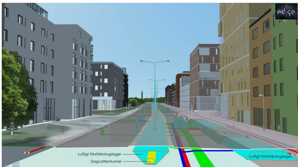
Figur 33. Tvärsektion på Fyrislundsgatan. Grönt illustrerar brunnar och ledningar för dagvatten och ljusblå (cyan) luftigt förstärkningslager (Bild: Edge AB).
